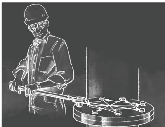
Всегда производите затяжку гаек по перекрестной схеме затяжки.
